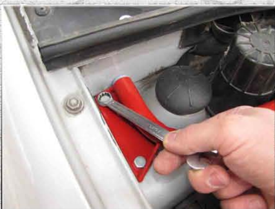
4. Ввести два болта М8 сверху правого стакана (чашки) брызговика и зафиксировать их;
