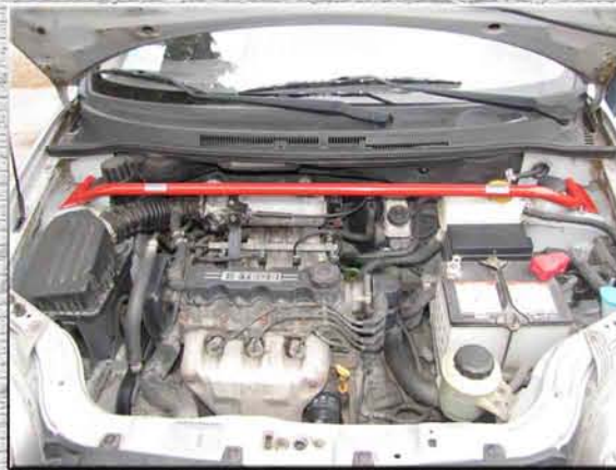
2. Поставить усилитель жесткости на стаканы (чашки) брызговика так, чтобы отверстия на усилителе жесткости совпадали с отверстиями на стаканах;
