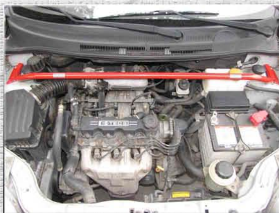
5. Проверить затяжку гаек и закрыть капот.
