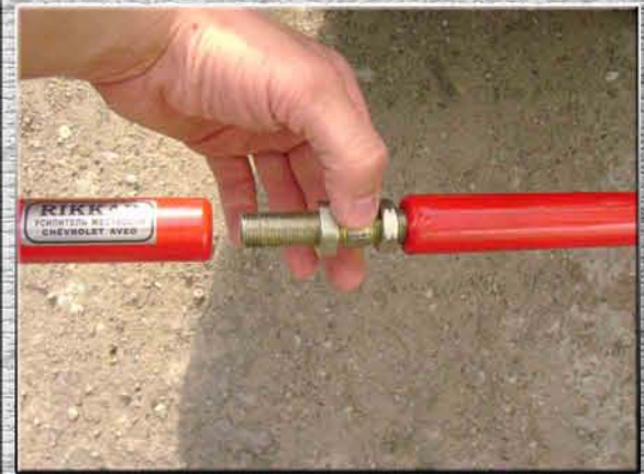
3. Вкрутить регулировочную шпильку в две части усилителя жесткости;
