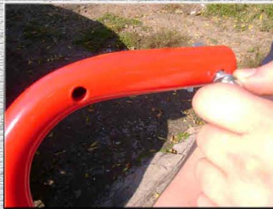
2. Открутить четыре гайки М8 на усилителе жесткости;
