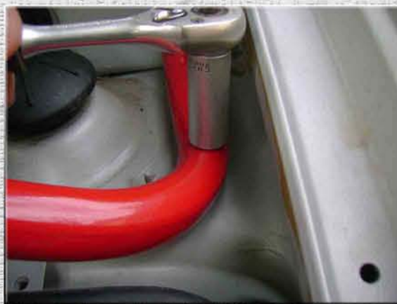
5. Закрутить две гайки М8 на болтах левого стакана (чашки) брызговика, выходящие с усилителя жесткости;
