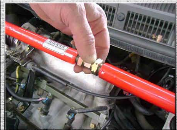
6. Отрегулировать ширину усилителя жесткости с помощью регулировочной шпильки (стяжки);
