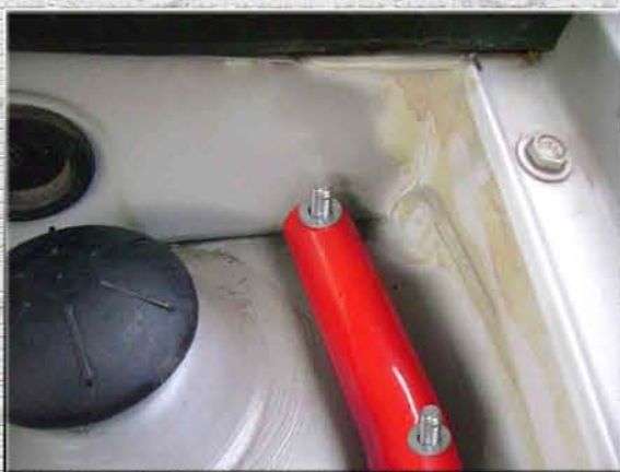
4. Ввести два болта М8 снизу левого стакана (чашки) брызговика так, чтобы они вышли наружу через усилитель жесткости;
