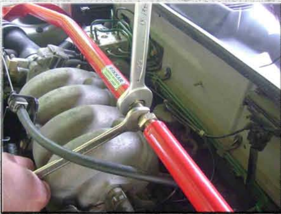
10. Зафиксировать размер усилителя жесткости на регулировочной шпильке правой...;
