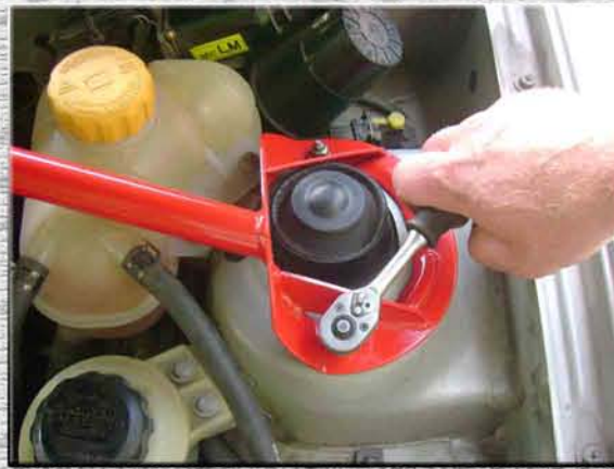
8. Закрутить на левой стойке (стакане, чашке) гайки М8;
