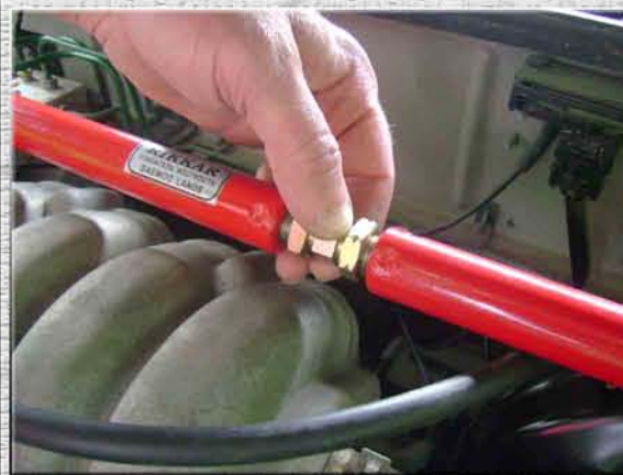
5. Отрегулировать ширину усилителя жесткости с помощью регулировочной шпильки;
