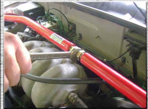
9. Разжать усилитель жесткости регулировочной шпилькой с усилием не более 1кг·с/м
