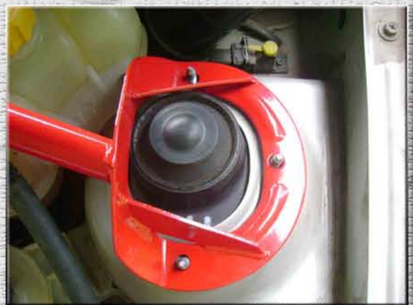
6. Одеть левое кольцо усилителя жесткости на шпильки левой стойки (стакана, чашки);
