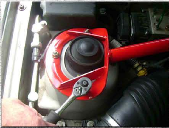
7. Закрутить на правой стойке (стакане, чашке) гайки М8;
