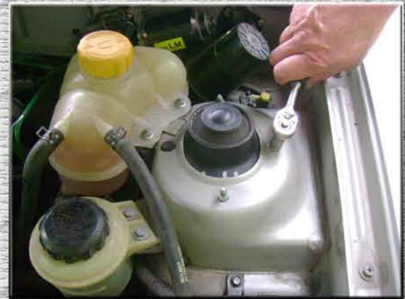
3. Открутить на левой стойке (стакане, чашке) гайки M8;
