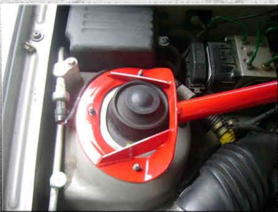
4. Одеть правое кольцо усилителя жесткости на шпильки правой стойки (стакана, чашки);
