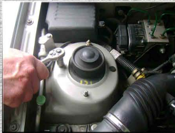
2. Открутить на правой стойке (стакане, чашке) гайки M8;
