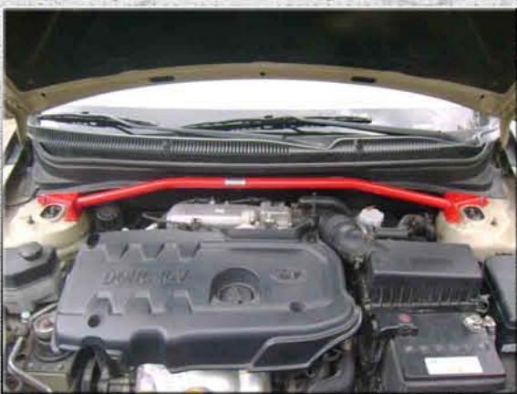
4. Посадить усилитель жесткости на шпильки стоек (стаканов, чашек);
