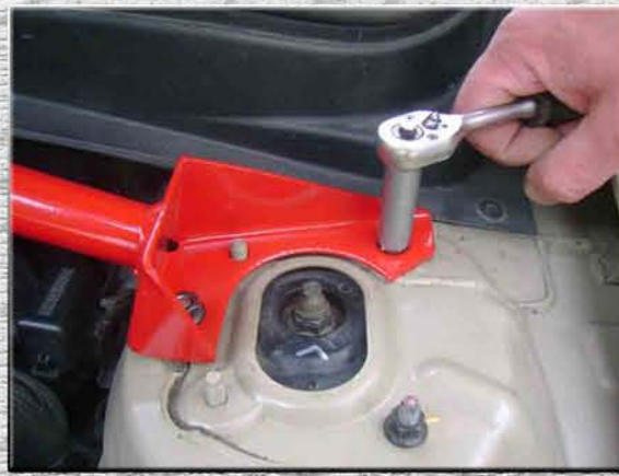
8. Закрутить на левой стойке (стакане, чашке) две гайки М8;
