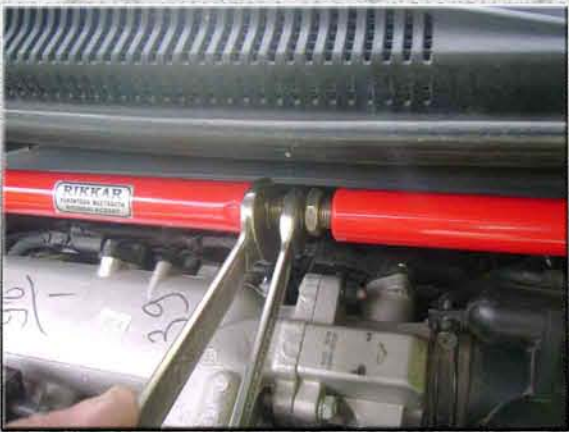
10. Зафиксировать размер усилителя жесткости контрящими гайками на регулировочной шпильке, сначала правой...;
