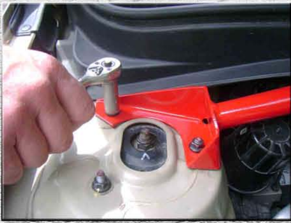
7. Закрутить на правой стойке (стакане, чашке) две гайки М8;
