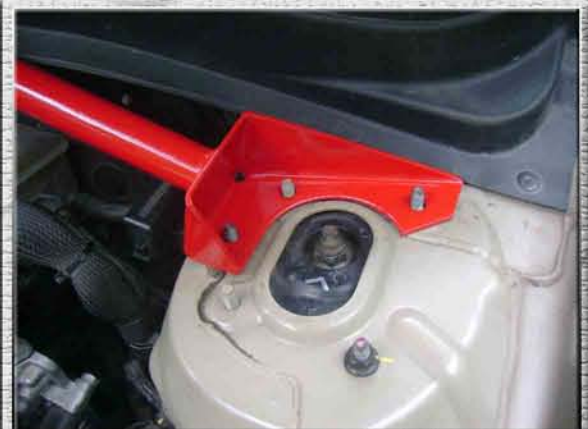
6. Посадить левое кольцо усилителя жесткости на шпильки левой стойки (стакана, чашки);
