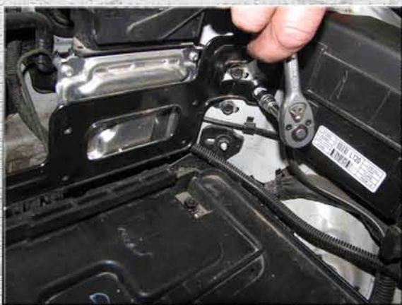
4. Снять с посадочного места планку, держащую ЭБУ;
