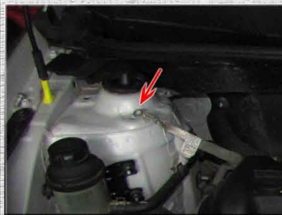
5. Снять клемму на правом стакане (чашке);
