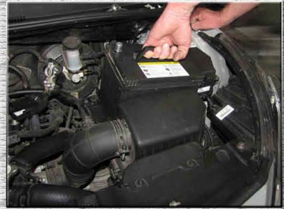
3. Произвести демонтаж аккумулятора предварительно сняв с него провод “+”;
