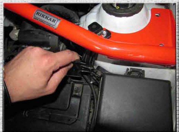
6. Установить усилитель жесткости на стаканы, а сверху на левом стакане установить кронштейн ЭБУ. На правом - наживить клемму болтом (пункт 5);
