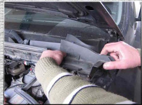
3. Демонтировать боковую часть пластиковой обшивки с обеих сторон предварительно сняв уплотнитель и заглушки;
