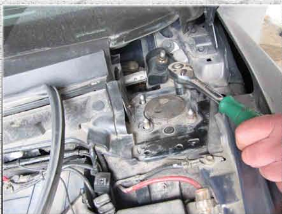
4. Открутить по 4-ре гайки M10 головкой на “14” с каждой стороны на стаканах, держащие опоры;
