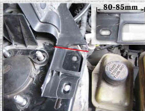
5. Отрезать часть пластиковой обшивки с обеих сторон, обозначенной красной линией, шириной 80-85мм ;
