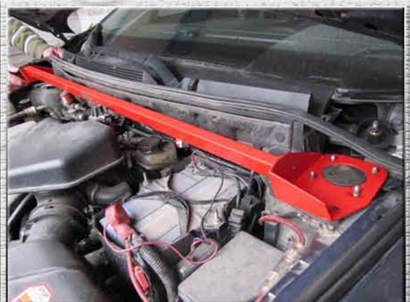
6. Одеть усилитель жесткости на шпильки опор;
